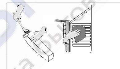
Канал для стока талой воды внутри холодильника следует периодически чистить. В случае засорения канала следует прочистить куском гибкой прочной лески.
